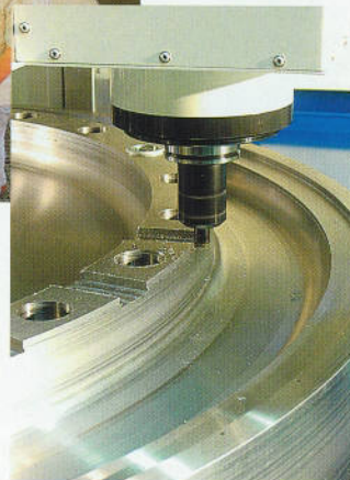
Portalbauweise, hydrostatischer Rundtisch und Bearbeitungseinheiten zum Schleifen, Drehen, Bohren und Fräsen in einer Aufspannung sind Kennzeichen des Planmaster RT.
